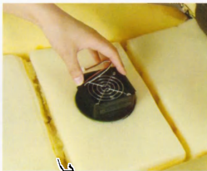
Шаг 4: Выберите подходящее место для установки вентиляторов в поропласте спинки и подушки сиденья (Примечание: выберите место за пределами пластин сиденья, которые препятствуют вентиляции, и за пределами зоны, где обычно расположены бедра пассажиров, чтобы обеспечить минимальную нагрузку и беспрепятственную вентиляцию).
