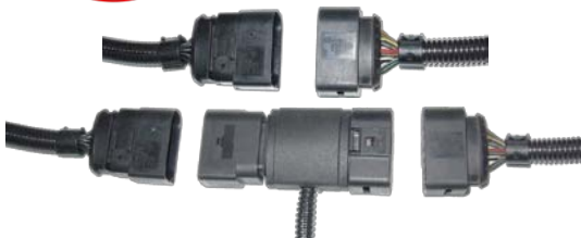
Фот.2 Подсоединение адаптера к насосу VP-37
