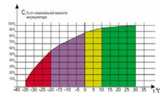
Сравнение номинальной емкости аккумулятора и суперконденсатора в зависимости от температуры окружающей среды
