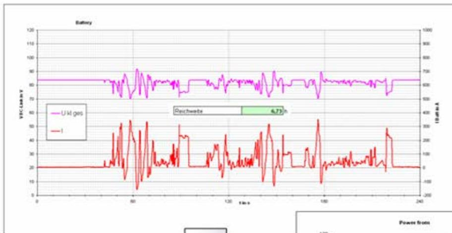
Ток и напряжение батареи без суперконденсатора
