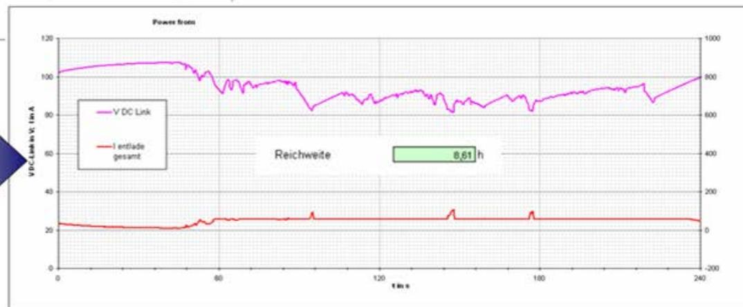
Ток и напряжение батареи при совместной работе с суперконденсатором
