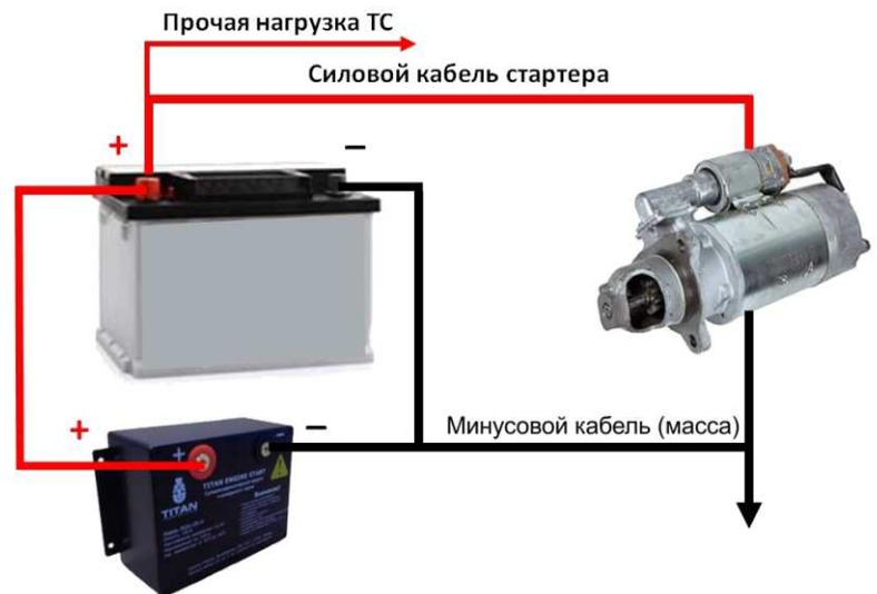
Единственным ограничением является затрудненность обеспечения гарантированного пуска при разряженной ниже 10В АКБ. Применение данной схемы оптимально в случае, когда штатная АКБ не изношена и в состоянии поддерживать напряжение не ниже 12В.
