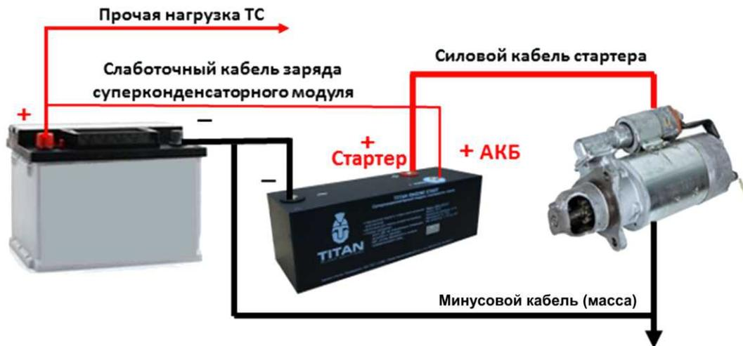
Схема подключения со встроенным в модуль преобразователем напряжения DC-DC (серия П)
