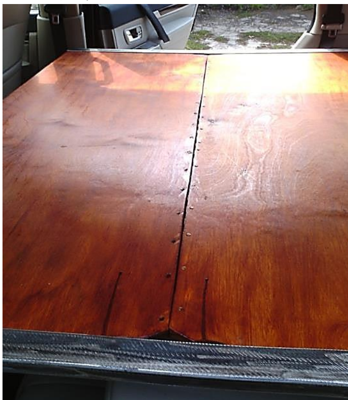
Рисунок 13 Зафиксированные профилями 2-е части по 130х50 см
