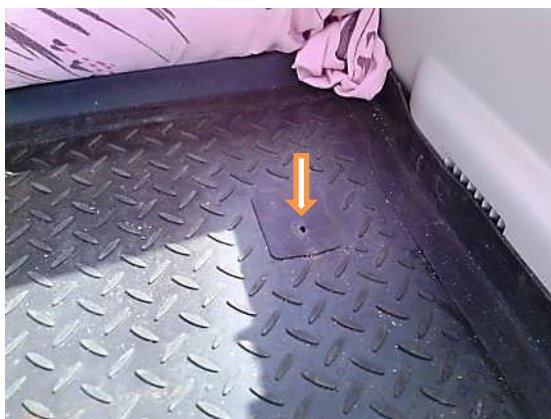
Рисунок 8 Место нахождения отверстия М8 (под поддоном)
