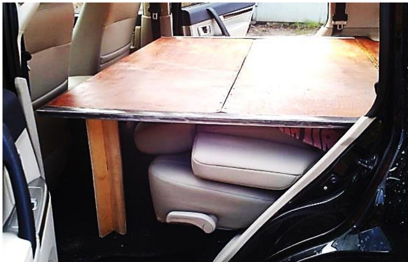
Рисунок 14 Подставки из «П» - образных пластин фанеры
