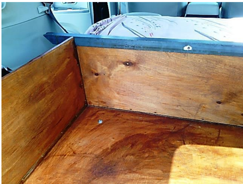
Рисунок 9 Болты М8 с шайбами крепления органайзера и уголок 40мм
