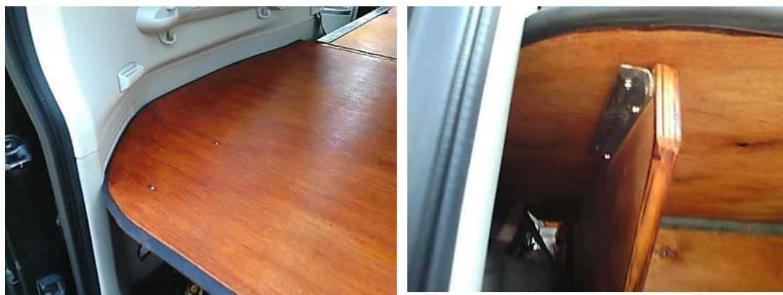
Рисунок 10 Место крепления фигурной части спального места к органайзеру
