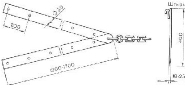
Рис. 20. Якорное устройство
