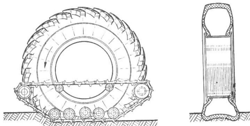
Рис. 7. Характер взаимодействия деформированной шины с грунтом 20
