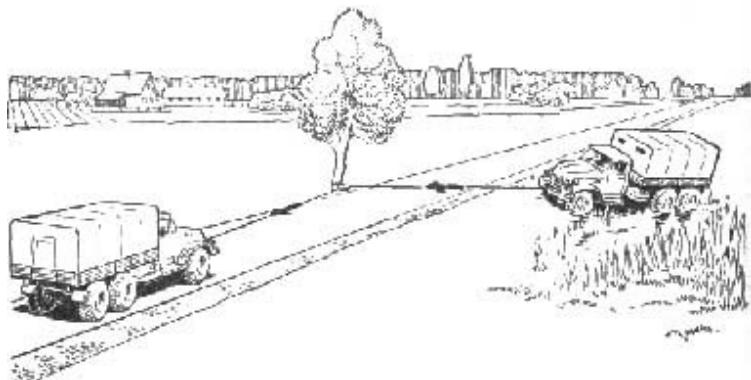
Рис. 17. Изменение направления тяги с помощью неподвижного блока
