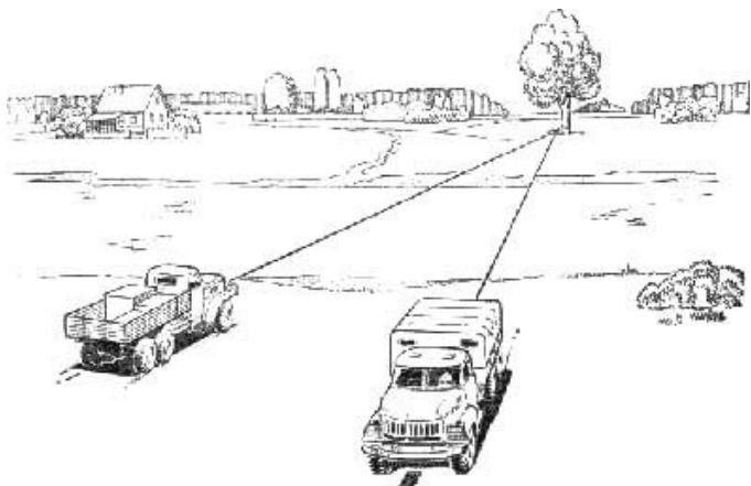
Рис. 14. Переправа через труднопроходимый брод с помощью длинного троса и блока
