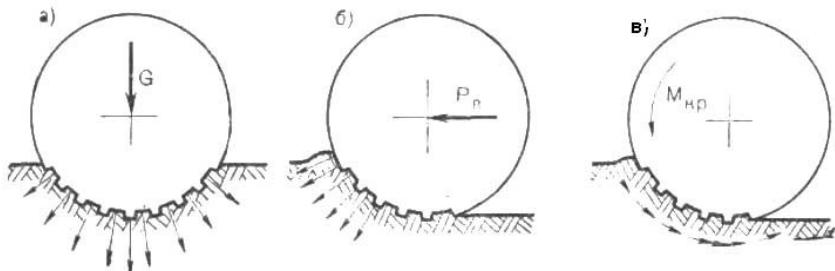
Рис. 3. Упрощенная схема сил, действующая в контакте колеса с грунтом
