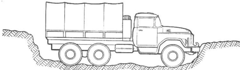
Рис. 23. Положение автомобиля «в распор»
