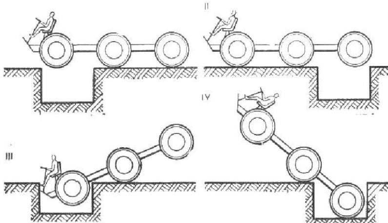
Рис. 24. Схема преодоления рва трехосным автомобилем равномерным расположением осей по базе
